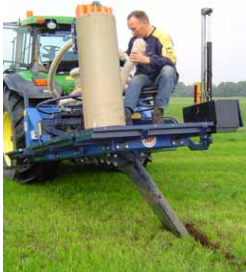
Figuur 27 Draineermachine van loonwerkbedrijf De Vlijt uit Noord-Beemster, waarmee ook op grasland sleufloos gedraineerd kan worden
